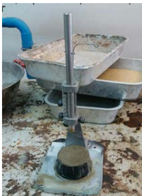
รูปที่ 1 การทดสอบการก่อตัวของมอร์ตาร์โดยการปล่อยเข็มไวแคทขนาด เส้นผ่านศูนย์กลาง 10 มม.
