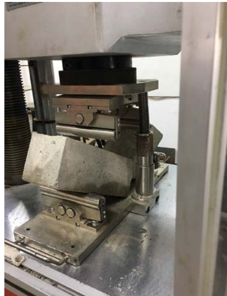
รูปที่ 2 การทดสอบกำลังค้ำค้ำด้วยเครื่องทดสอบแรงดึง แรงค้ำและแรงอัด แบบไฮดรอลิก
