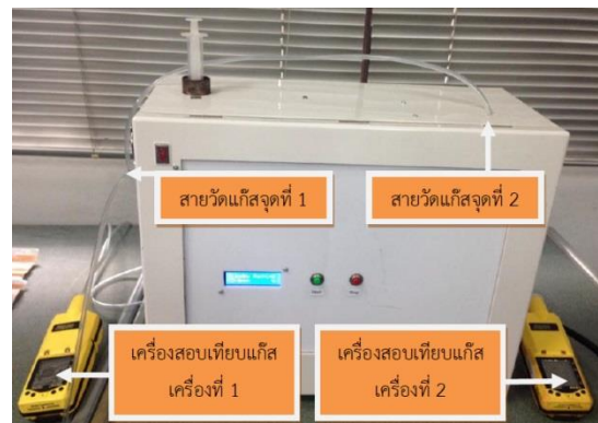
รูปที่ 9 เสียบสายดูดอากาศเครื่องสอบเทียบแก๊ส เครื่องที่ 1 และ 2 เข้ากับตัวเครื่อง
