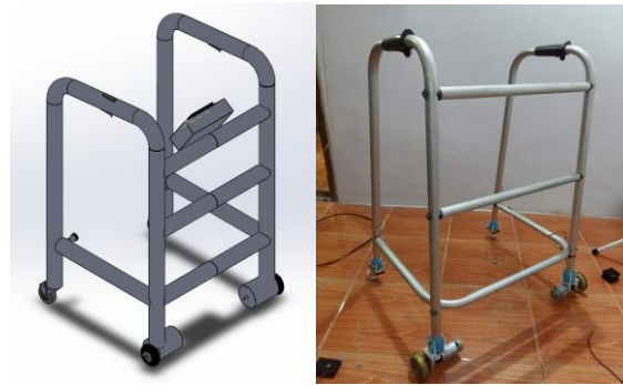
(ก) โครงสร้างที่ออกแบบไว้ (ข) เครื่องที่ประกอบแล้ว รูปที่ 7 โครงสร้างเครื่องที่คิดล้อและมอเตอร์
