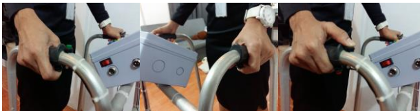
รูปที่ 10 การกดสวิทช์เลี้ยวซ้าย-ขวาและถอยหลังในโมคดัดโนมัติ
