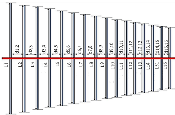
รูปที่ 1 โครงสร้างสายอากาศสี่อวกาศสี่อวกาศถี่ 87-137MHz
