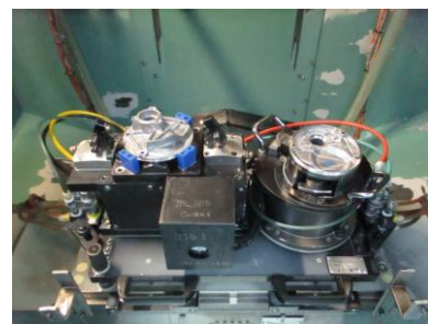
รูปที่ 2.4 เครื่องมือจับยึดชิ้นงานใหม่สำหรับเครื่องปาดหน้า เจาะรู ทำเกลียว (CNC Tapping Center)
