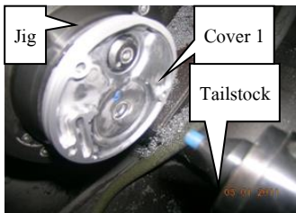
รูปที่ 2.1 อุปกรณ์จับยึดชิ้นงานฝาครอบ (Cover) ของเครื่องกลึงอัตโนมัติ (CNC Lathe)
