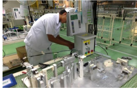
รูปที่ 7 การติดตั้งจิ๊กที่โรงงาน
