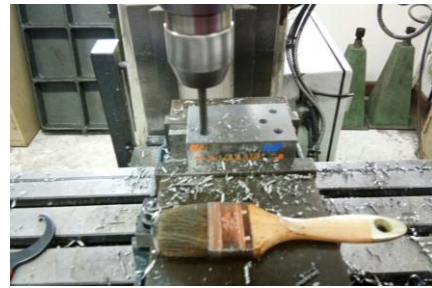
รูปที่ 6 สร้างแม่พิมพ์ด้วยเครื่อง Milling
