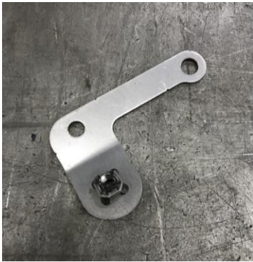
รูปที่ 9 ชิ้นงานที่ได้จากการขึ้นรูปด้วยแม่พิมพ์
