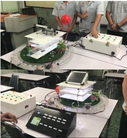
รูปที่ 10 อุปกรณ์ต้นแบบ PV Simulator for Design and Installation Systems
