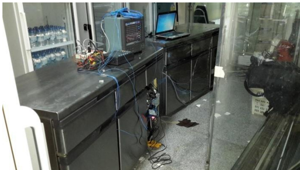
รูปที่ 2 การติดตั้งตู้แช่เย็นเพื่อทดสอบเปรียบเทียบ
