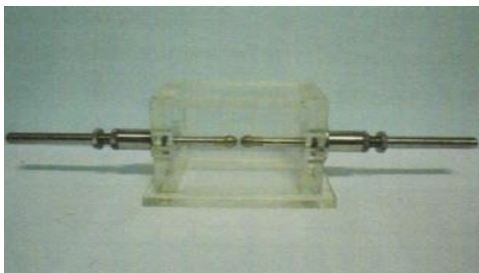
รูปที่ 7 ชุดทดสอบน้ำมันหม้อแปลงมาตรฐาน IEC 156
