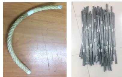
รูปที่ 2 วัสดุเส้นใยที่ใช้ในการเสริมกำลังของแผ่นพื้นเส้นใยป่านศรนารายณ์ (ซาย) และแผ่น CFRP (ขาว)
