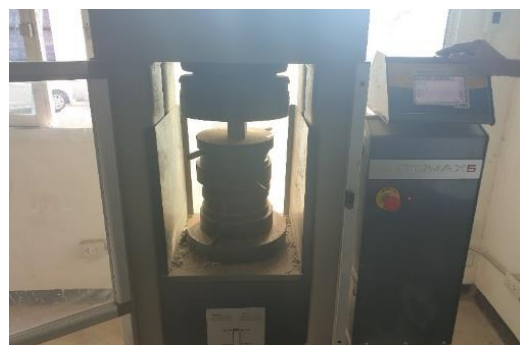
รูปที่ 1 ทดสอบกำลังรับแรงอัดโดยใช้เครื่องทดสอบ
