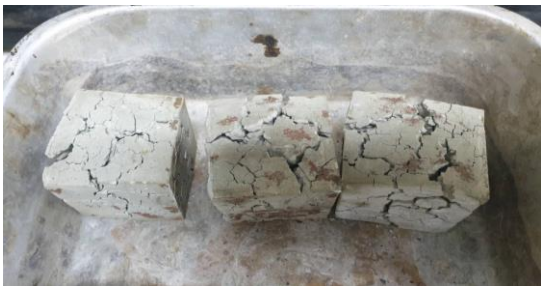
รูปที่ 2 ทดสอบกำลังรับแรงอัดโดยใช้เครื่องทดสอบ
