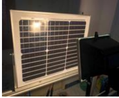
รูปที่ 2 แสดงภาพตัวอย่างการทดลองด้วยแสงจากหลอดไฟ
