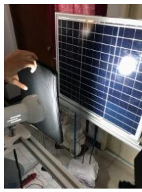
รูปที่ 3 แสดงภาพตัวอย่างการทดลองแบบหน้าแผงมีสิ่งบดบัง
