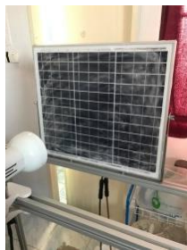
รูปที่ 3 แสดงภาพตัวอย่างการทดลองแบบหน้าแผงมีสิ่งบดบัง
