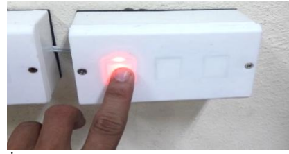
รูปที่ 12 การทดสอบใช้งานชุดควบคุมผ่านสวิตช์สัมผัส
