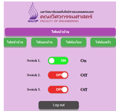
รูปที่ 13 การทดสอบใช้งานชุดควบคุมผ่านทางเว็บเบราว์เซอร์
