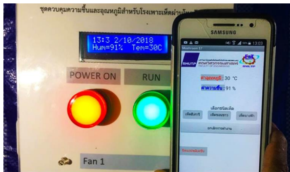
รูปที่ 5 ค่าข้อมูลที่แสดงบนหน้าจอ LCD และที่หน้าจอแอปพลิเคชันบนโทรศัพท์มือถือ
