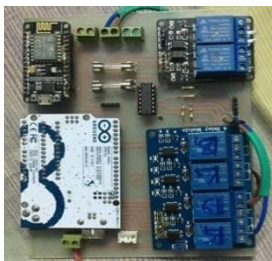
รูปที่ 2 แผงวงจรและกล่องวงจรชุดควบคุมความชื้นและอุณหภูมิเมื่อสร้างเสร็จ
