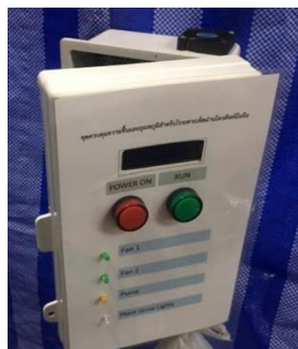
รูปที่ 2 แผงวงจรและกล่องวงจรชุดควบคุมความชื้นและอุณหภูมิเมื่อสร้างเสร็จ
