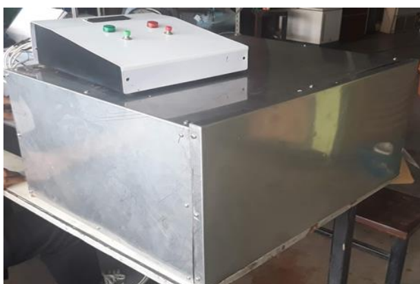
รูปที่ 6 ตู้อบความร้อนแบบอินฟราเรดสำหรับแผงวงจรพิมพ์ที่สมบูรณ์
