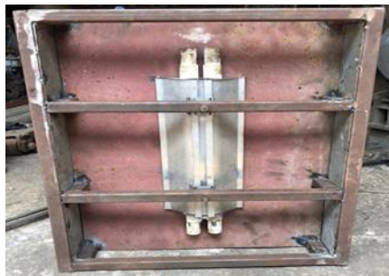
รูปที่ 4 ตำแหน่งหลอดอินฟราเรดภายในตู้อบ
