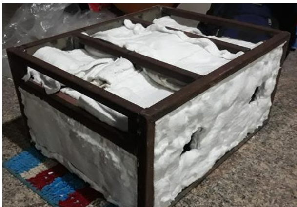
รูปที่ 5 ฉนวนกันความร้อนที่ใส่ไว้บริเวณผนังตู้อบความร้อน
