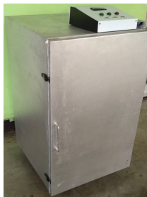
รูปที่ 6 ตู้อบสมุนไพรควบคุมอุณหภูมิและความชื้นที่เสร็จสมบูรณ์
