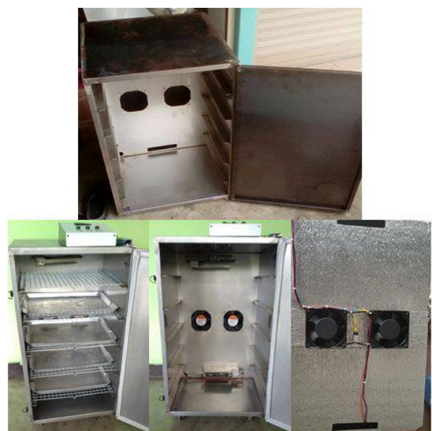
รูปที่ 4 การติดตั้งอุปกรณ์ต่างๆ
