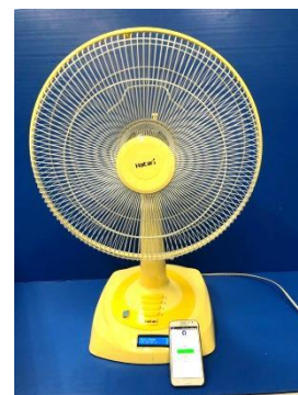
รูปที่ 3 พัดลมอัจฉริยะและควบคุมผ่านแอปพลิเคชันแอนดรอยด์ที่ประกอบเข้ากับพัดลมเสร็จแล้ว
