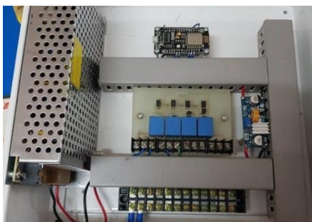
รูปที่ 2 เครื่องเตือนภัยบ้านผ่านมือถือที่ประกอบเสร็จแล้ว
