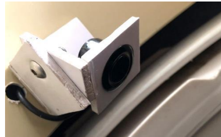
รูปที่ 4 ตำแหน่งติดตั้งเซ็นเซอร์ตรวจสอบผ้าภายในถังซัก
