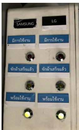
รูปที่ 3 ด้านบนของกล่องควบคุมแสดงสถานะการทำงานเครื่องซักผ้า
