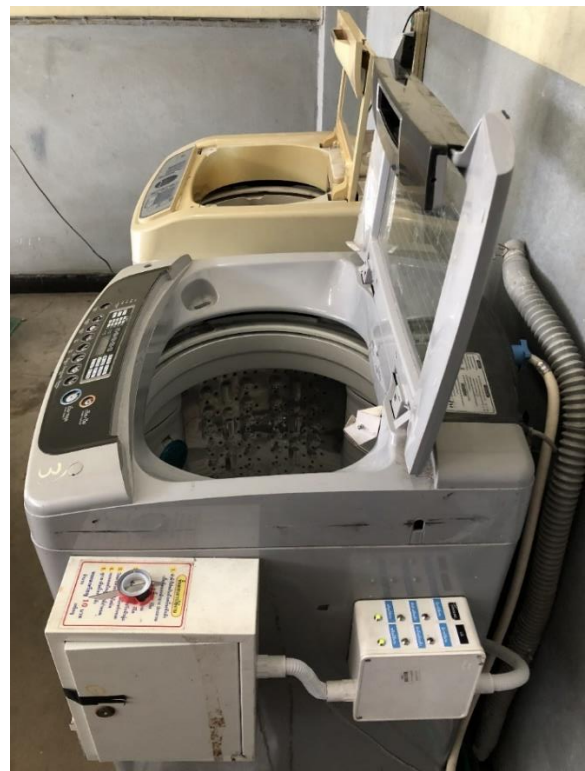
รูปที่ 5 การติดตั้งกล่องควบคุมเข้ากับเครื่องซักผ้า
