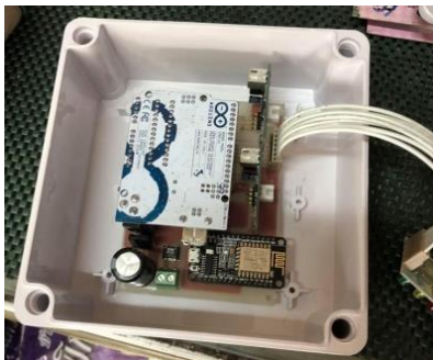
รูปที่ 2 ภายในกล่องชุดควบคุมการทำงานของเครื่องซักผ้า
