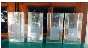
รูปที่ 2 การนำยางซิลิโคนพักทิ้งไว้ในอุณหภูมิปกติ
