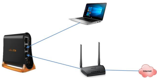
รูปที่ 2 โครงสร้างการเชื่อมต่อเพื่อตั้งค่าเริ่มต้นให้กับอุปกรณ์
