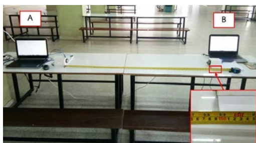
รูปที่ 4 การติดตั้งเครื่องรับ-ส่งข้อมูลทางแสงที่มองเห็นระยะ 150 ซม. ได้ สำหรับรับ-ส่งข้อมูลตัวอักษรด้วยไฟล์ชนิด .txt
