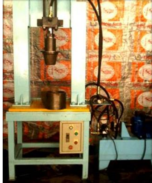
รูปที่ 4 เครื่องอัดขึ้นรูปกระดาษจากผักตบชวา
