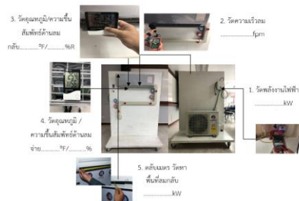
รูปที่ 2 ตำแหน่งการตรวจวัดสำหรับหาค่าดัชนีการใช้พลังงานของระบบปรับอากาศแบบแยกส่วน
