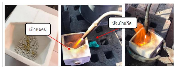
รูปที่ 1 การหลอมโลหะเงิน+ทองแดง+ตามสัดส่วนที่กำหนดแพลเลเดียม
