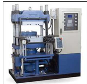
รูปที่ 4 เครื่องอัดขึ้นรูปผลิตภัณฑ์ยาง [4]
