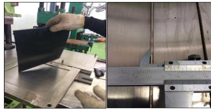
รูปที่ 5 แสดงแผ่นยางที่ขึ้นรูปด้วยแม่พิมพ์
