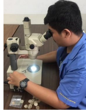
รูปที่ 6 ลักษณะการตรวจสอบคุณภาพรอยเชื่อมอาร์คกับน้ำประสานด้วยกล้องจุลทรรศน์
