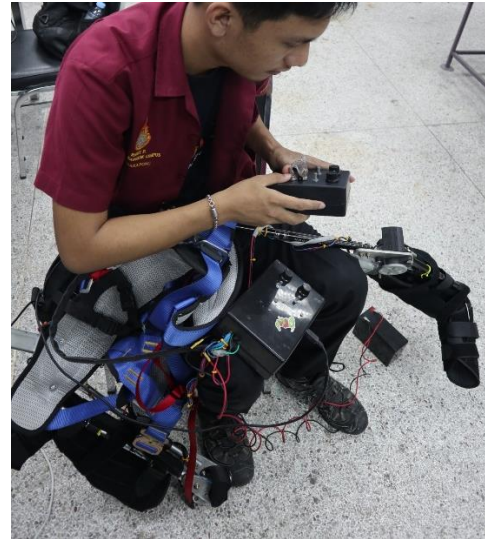
รูปที่ 6 ทดสอบการหมุนของมอเตอร์บริเวณสะโพก
