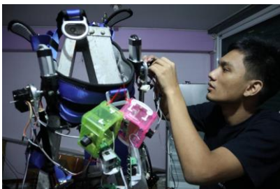
รูปที่ 5 การติดตั้งชุดควบคุม
