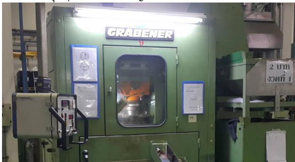
ภาพที่ 8 ภาพเครื่องปั๊มเหรียญ ชนิดราคา 2 บาท
