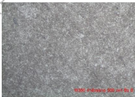
ภาพที่ 16 W360 สภาพจำหน่าย Nitric 5%(50X)
