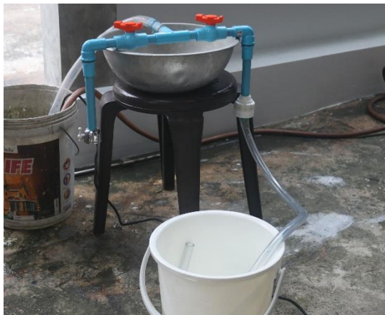
ภาพที่ 5 การทดลองล้างคราบ-5 แบบ เปรียบเทียบระหว่าง วาล์วประหยัดน้ำกับวาล์วปกติ
