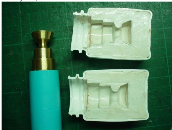
ภาพที่ 3 แบบจำลองวาล์วทองเหลืองและปูนพลาสติก
