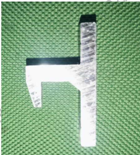
ภาพที่ 7 ตัวรับล๊อคที่ทำการออกแบบมาใช้งานกับ Section ที่ปรับปรุงของบริษัทฯ
