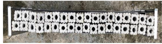
รูปที่ 9 วางเซรามิกบาร์เข้ากับโครงสร้างงาน
