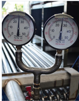
รูปที่ 17 ผลการทดสอบไม่พบการรั่วที่ความดัน 25 บาร์
