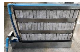
รูปที่ 11 ติดตั้งถาดรองน้ำ ท่อน้ำสำหรับการจ่ายน้ำให้เซรามิกบาร์ สายยาง และปั้มน้ำ
