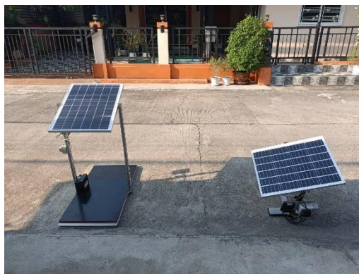
รูปที่ 5 การติดตั้งเซลล์แสงอาทิตย์ที่หันไปทางทิศใต้ทำมุม 15 องศา กับแนวระนาบ และการติดตั้งเซลล์แสงอาทิตย์ชนิดหมุนตามแสง
