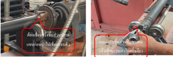
รูปที่ 8 การปรับปรุงการตั้งตำแหน่งชิ้นส่วนปลายแขนด้วย fixture
