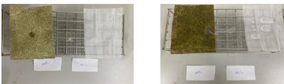
รูปที่ 2 ความสามารถในการอุ้มน้ำของแผ่นกรองหน้ากากอนามัย
