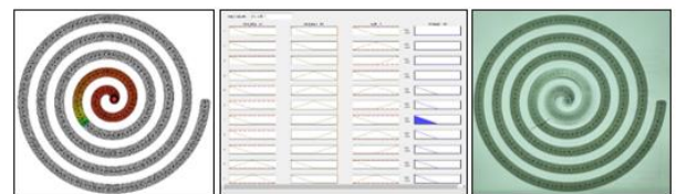
รูปที่ 10 การจำลองการไหล Moldex3D : (a) ,แสดงการวิเคราะห์ตรรกศาสตร์คลุมเครือโดยใช้โปรแกรม MATLAB : (b) และชิ้นงานที่ทดลองฉีด : (c) ภายใต้เงื่อนไขการฉีดขึ้นรูปเดียวกัน
