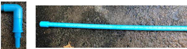
รูปที่ 7 ท่อน้ำสำหรับการจ่ายน้ำให้เซรามิกบาร์
