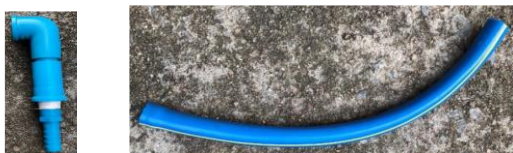
รูปที่ 8 ข้อต่อสำหรับติดตั้งกับก๊อมน้ำลูกกลอย และสายยางขนาด 30 เซนติเมตร
