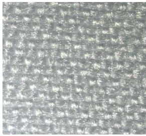
ภาพที่ 2 ผ้าโพลีเอสเตอร์ที่มาจากการรีไซเคิล จากกล้องจุลทรรศน์ ที่กำลังขยาย 30X
