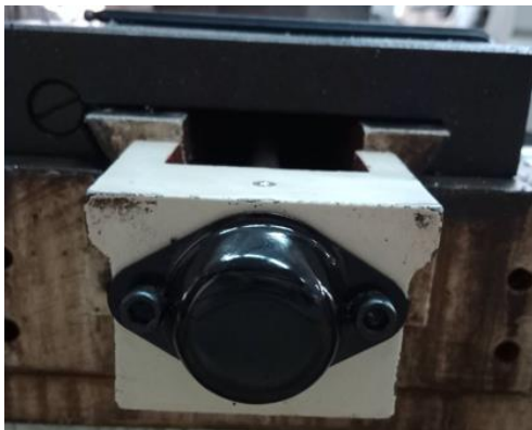
รูปที่ 9 ผ่าครอบตัวยึดที่ประกอบเข้ากับแท่นตัดขวางเครื่องกลึง
