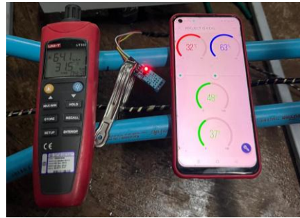
รูปที่ 6 การวัดระหว่างมิเตอร์มาตรฐานกับหน้าจอแอปพลิเคชัน Blynk
