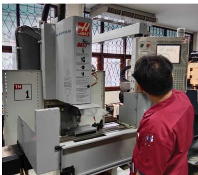
รูปที่ 4 การเจาะรูชิ้นส่วนแม่พิมพ์ด้วยเครื่อง CNC
