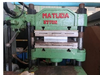
รูปที่ 10 Preheat แม่พิมพ์ ที่อุณหภูมิ 150 องศาเซลเซียส เวลา 30 นาที
