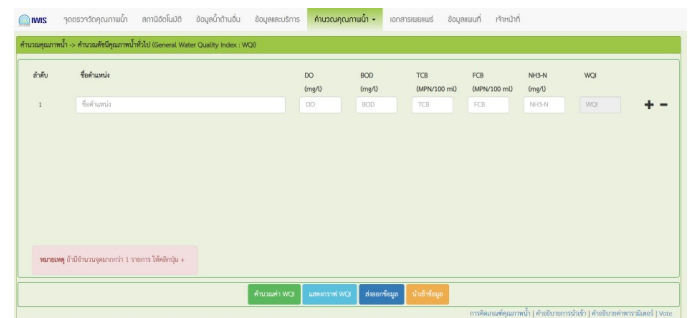
รูปที่ 2 การคำนวณดัชนีคุณภาพน้ำ (WQI) โดยใช้ระบบฐานข้อมูลคุณภาพน้ำแหล่งน้ำผิวดินทั่วประเทศ (IWIS)
