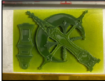
รูปที่ 5 ชิ้นงานที่ทำการขึ้นต้นแบบ Wax 3d printer
