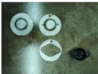
รูปที่ 5 ลำดับการผลิตฝาครอบปลายเกลียว
