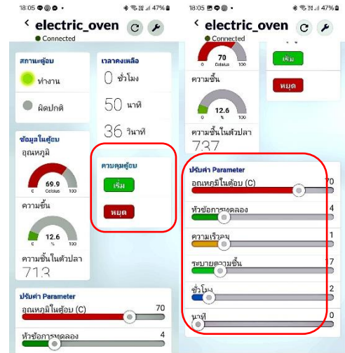
รูปที่ 7 ตำแหน่งการควบคุมตู้อบและปรับค่าพารามิเตอร์จากโทรศัพท์มือถือ
