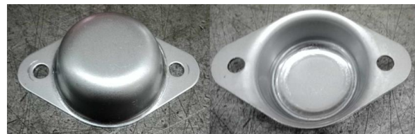
รูปที่ 7 ชิ้นงานที่ผ่านกระบวนการตัดขอบและเจาะรู
