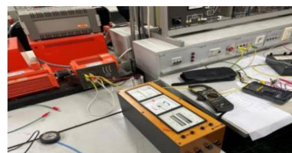
รูปที่ 5 การทดสอบมอเตอร์เหนี่ยวนำ 3 เฟสมาใช้กับระบบไฟฟ้า 1
