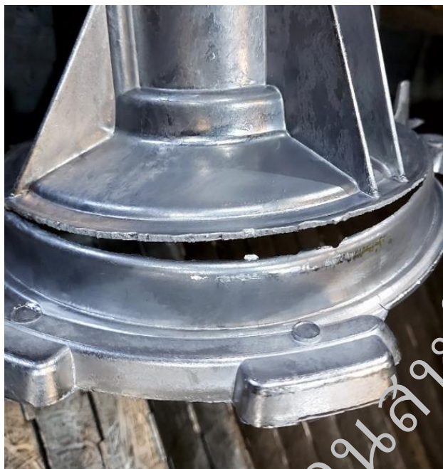
รูปที่ ค.3 ตัวอย่างปัญหาชิ้นงานรอยร้าว (CRACK)
