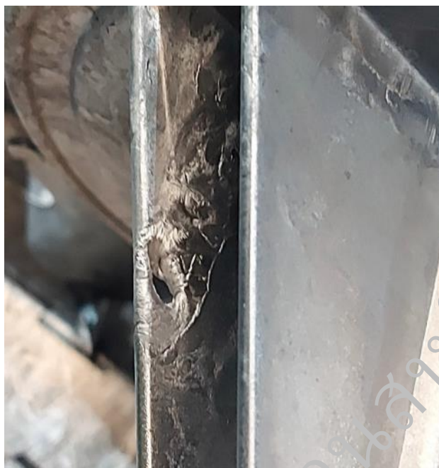
รูปที่ ค.7 ตัวอย่างปัญหาชิ้นงานเนื้อไม่ประสาน (MISRUN)
