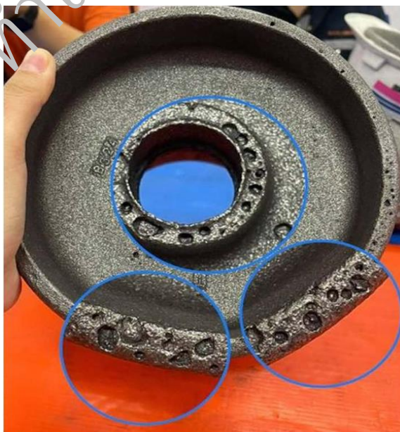
รูปที่ 2.8 ตัวอย่างชิ้นงาน Blow hole
