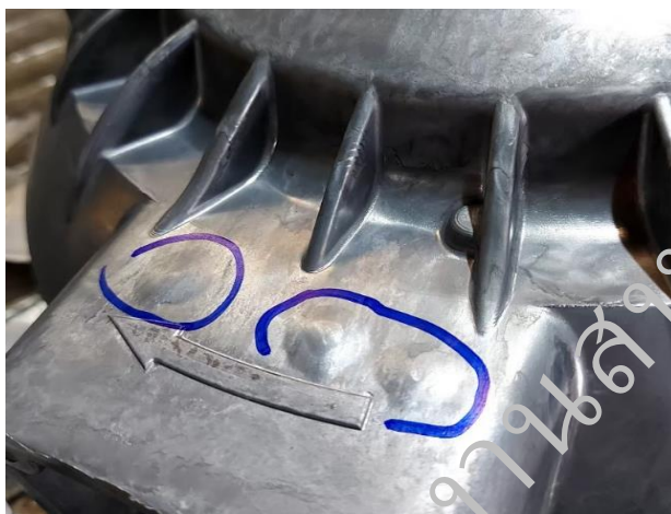
รูปที่ 2.7 ตัวอย่างชิ้นงาน Swell
